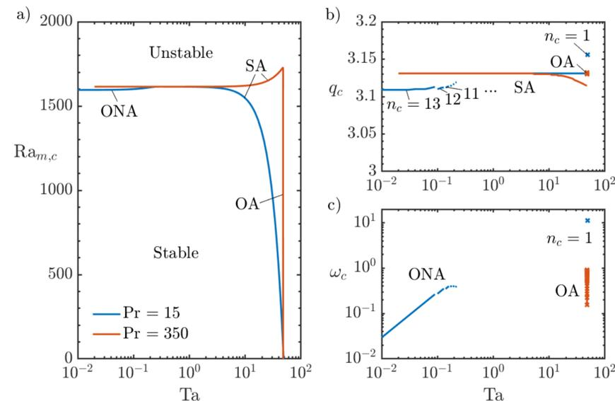
Paramètres critiques en fonction de  $Ta$  pour  $\mu = 0, \eta = 0.8, \gamma_a = 0,01$  et pour deux ferrofluides différents.
