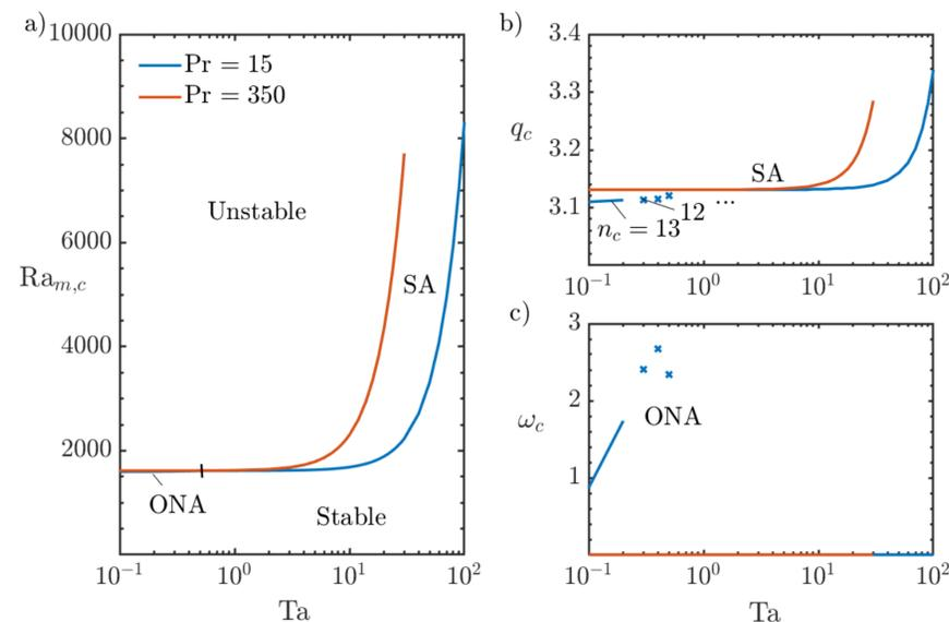
Paramètres critiques en fonction  $Ta$  pour  $\mu = \eta^{3/2}, \eta = 0.8, \gamma_a = 0.01$  et pour deux ferrofluides différents.
